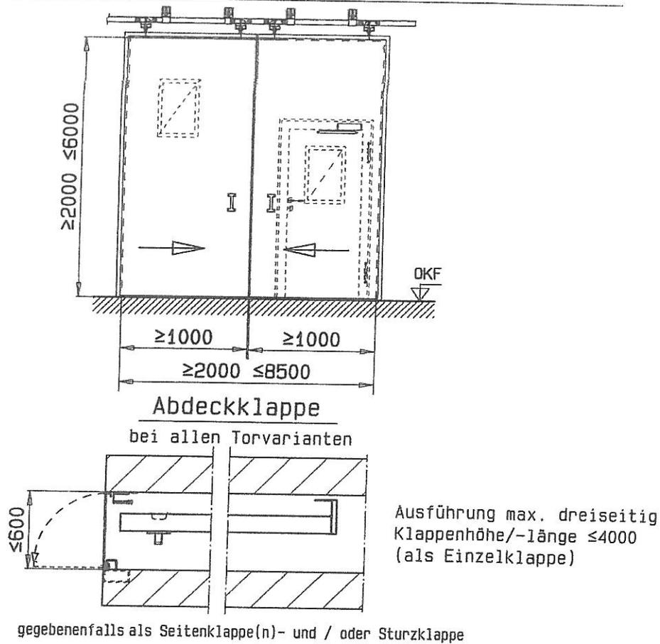
T 90-1-FSA "System Schröders TSN-16" bzw. T 90-1-RS-FSA "System Schröders TSN-16"
